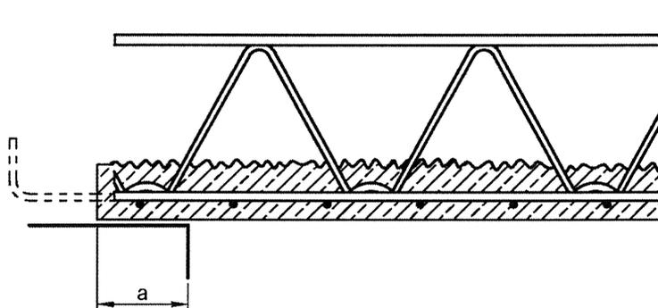
$a \geq 35 \text{ mm}$  und stets je Gitterträger ein Untergurtknotenpunkt hinter der Auflagervorderkante
