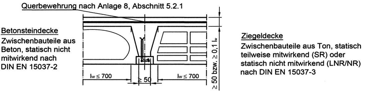
Bild 7: Rippendecke nach Anlage 8, Abschnitt 5
