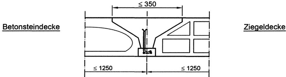
Bild 5: Rippendecke nach Anlage 8, Abschnitt 5
