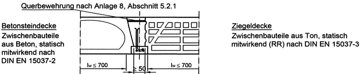
Bild 6: Rippendecke nach Anlage 8, Abschnitt 5
