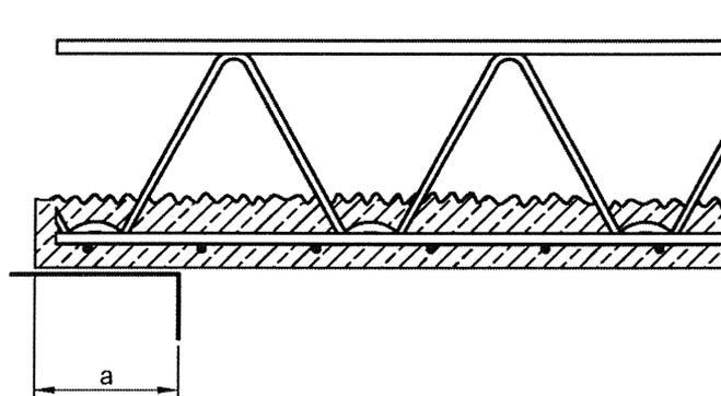
$a \geq 100 \text{ mm}$  und stets je Gitterträger ein Untergurtknotenpunkt hinter der Auflagervorderkante
