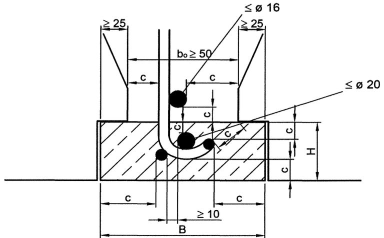
$c = c_{nom}$  nach DIN EN 1992-1-1 mit DIN EN 1992-1-1/NA, Abschnitt 4.4.1
