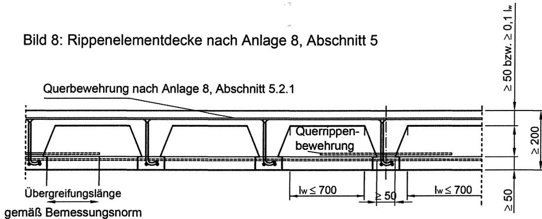
Bild 9: Elementrippendecke nach Anlage 8, Abschnitt 5
